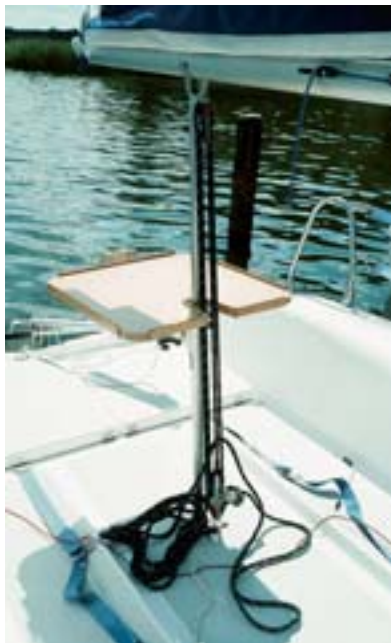
Cockpit in Hafenmodus, der Tisch wird an der Baumstütze aufgesteckt
